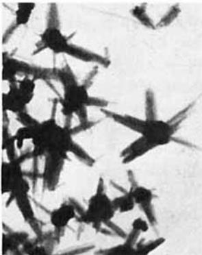
Fig. 13.  $\alpha$ -Fe<sub>2</sub>O<sub>3</sub> mit Auswüchsen
