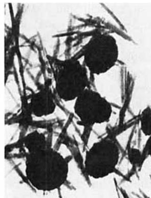
Fig. 14.  $\alpha$ -Fe<sub>2</sub>O<sub>3</sub> und  $\alpha$ -FeOOH
